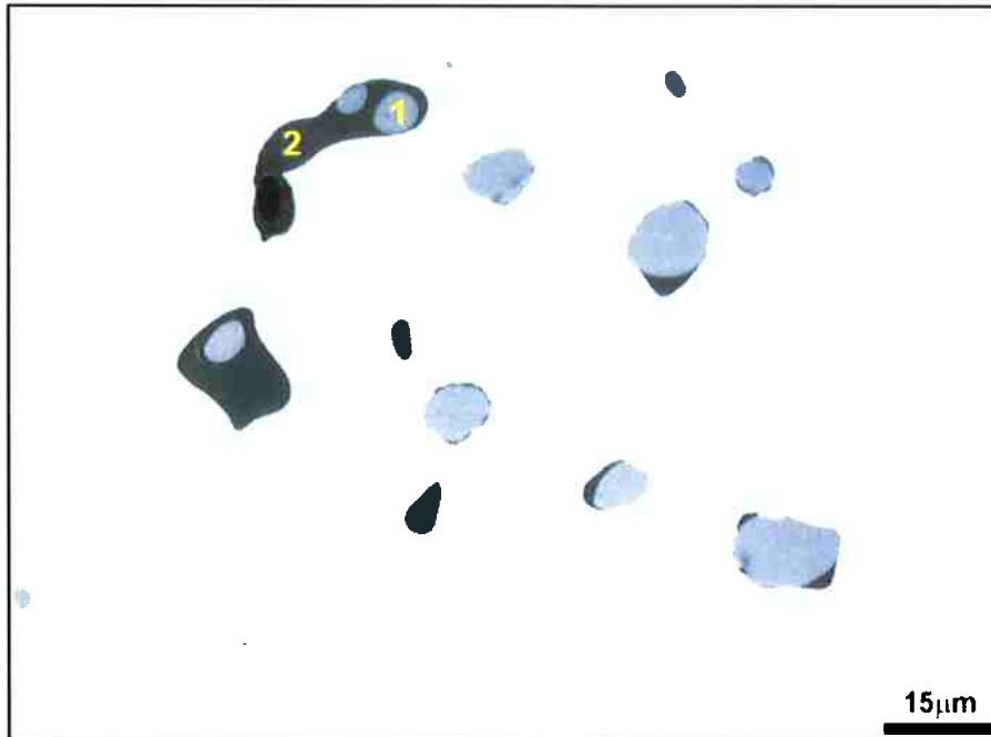
Figura 69. Inclusão amostra 135 1000X, com presença de duas fases, vítrea e wustita.
