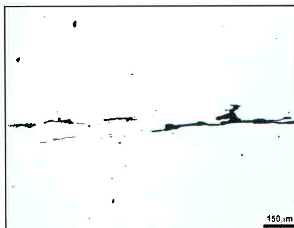
Figura 7. Inclusões alongadas microscopia ótica 100X. (Fotografia tomada por Rafael Rocha Maia 2014).
