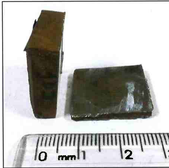
Figura 20. Amostra 133, seção transversal quadrada de 25X25 mm. (Fotografia tomada por Cassio Junqueira 2015.).
