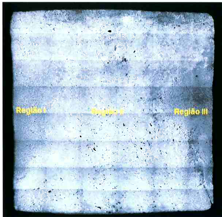
Figura 55. Mosaico amostra 133 mostrando a divisão com três regiões pelo conteúdo de perlita.
