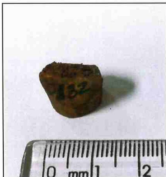
Figura 18. Amostra 132, barra de diametro 8 mm. (Fotografia tomada por Cassio Junqueira 2015.)
