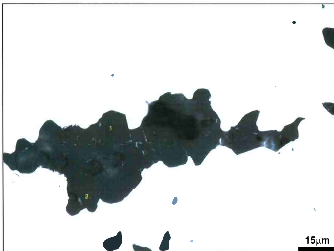
Figura 73. Inclusão amostra 135 1000X com duas fases presentes.
