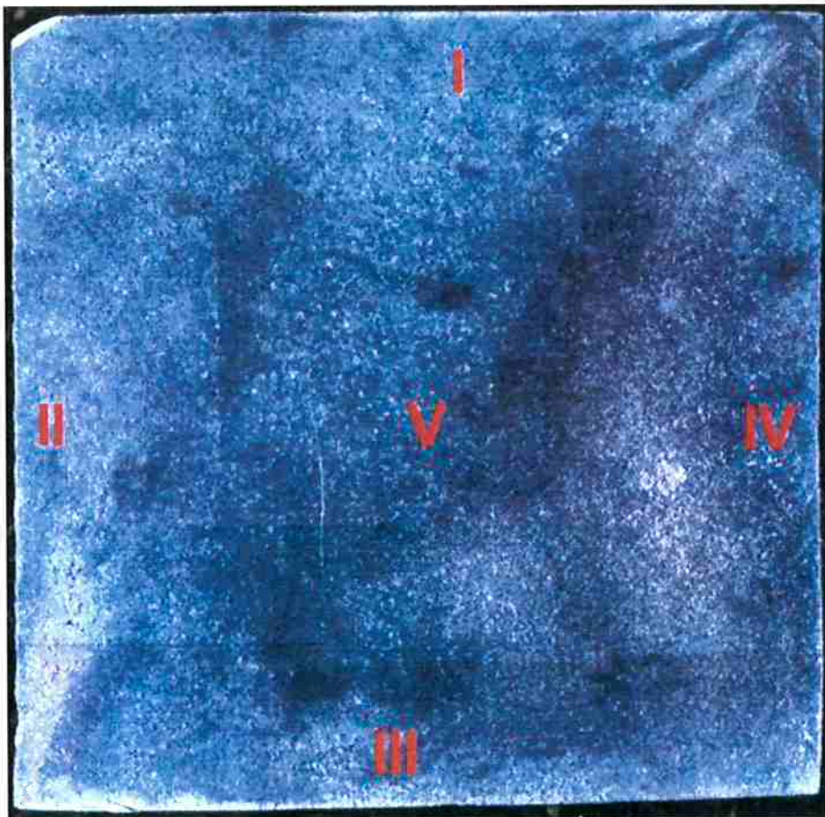
Figura 30. Mosaico amostra 135 divisão para as medidas de micro dureza Vickers
