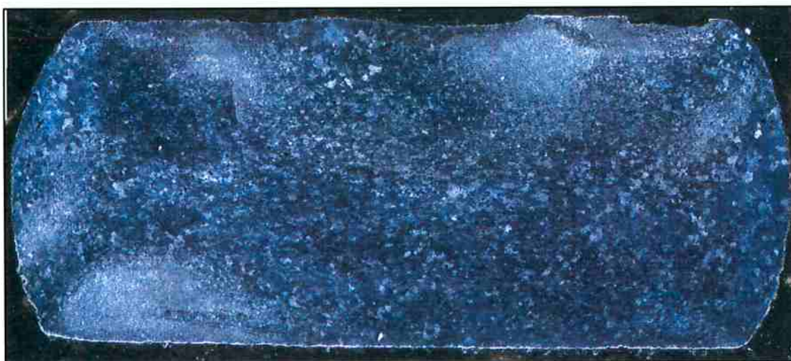
Figura 22. Macrografia Amostra 130, contem regiões atacadas diferentemente, zonas cinzas, brancas e pretas.
