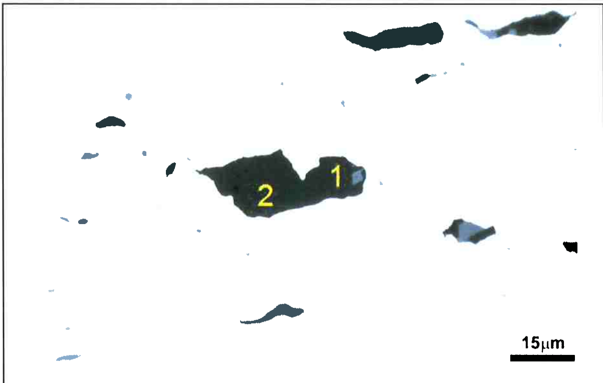
Figura 35. Inclusões Amostra 129 1000X, se observam duas fases: vitrea e ilmenita.
