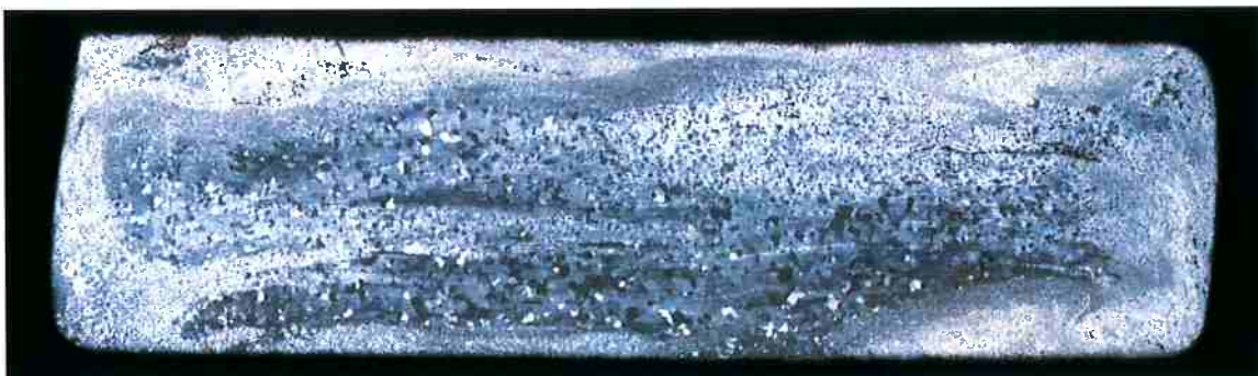
Figura 21. Macrografia Amostra 129. Se observam zonas atacadas diferentemente.
