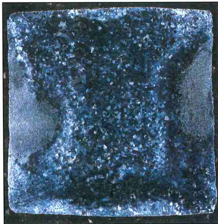
Figura 24. Macrografia amostra 133, com regiões cinzas, pretas e brancas.
